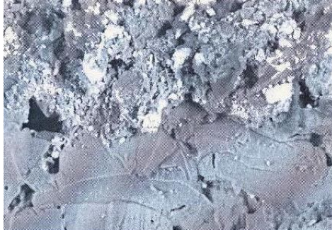
Рис.3. Структура перехідного шару на межі контакту покриття-сплав XH78T (x500)
