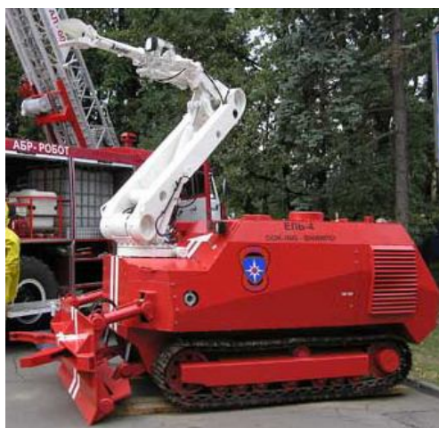
Рис. 1. Багатофункціональний робототехнічний комплекс пожежогасіння середнього класу «Ель-4» (Росія)
