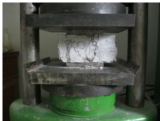
Рис. 12. Випробування половинки призми на міцність при стиску
