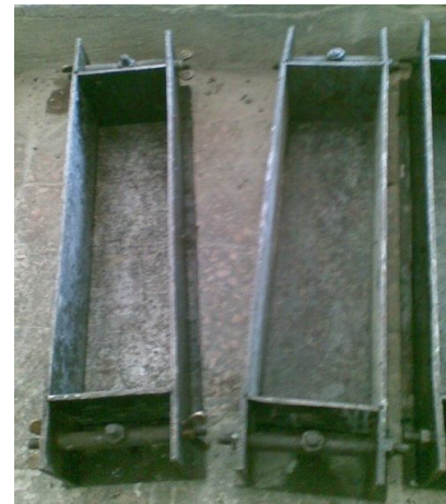
Рис. 4. Одномісна форма для виготовлення зразків у вигляді призми ФП – 100
