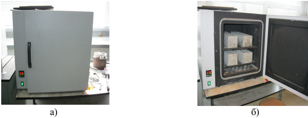
Рис. 7. Витримка зразків у електричній муфельній печі: а) в робочому режимі; б) у момент завантаження зразків
