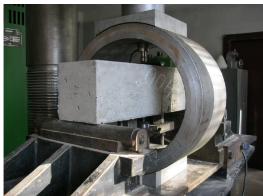
Рис. 11. Випробування призми на тріщиностійкість
