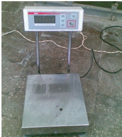
Рис. 3. Ваги електронні лабораторні марки V 15 IR
