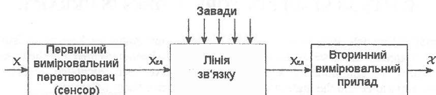
Рис. 1. Узагальнена структурна схема електричного приладу для вимірювання неелектричних величин [3]
