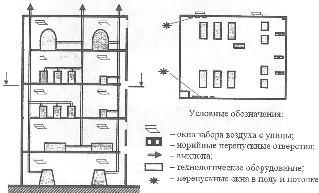
Рис. 1. Схема мельничного корпуса и разрез его этажа
