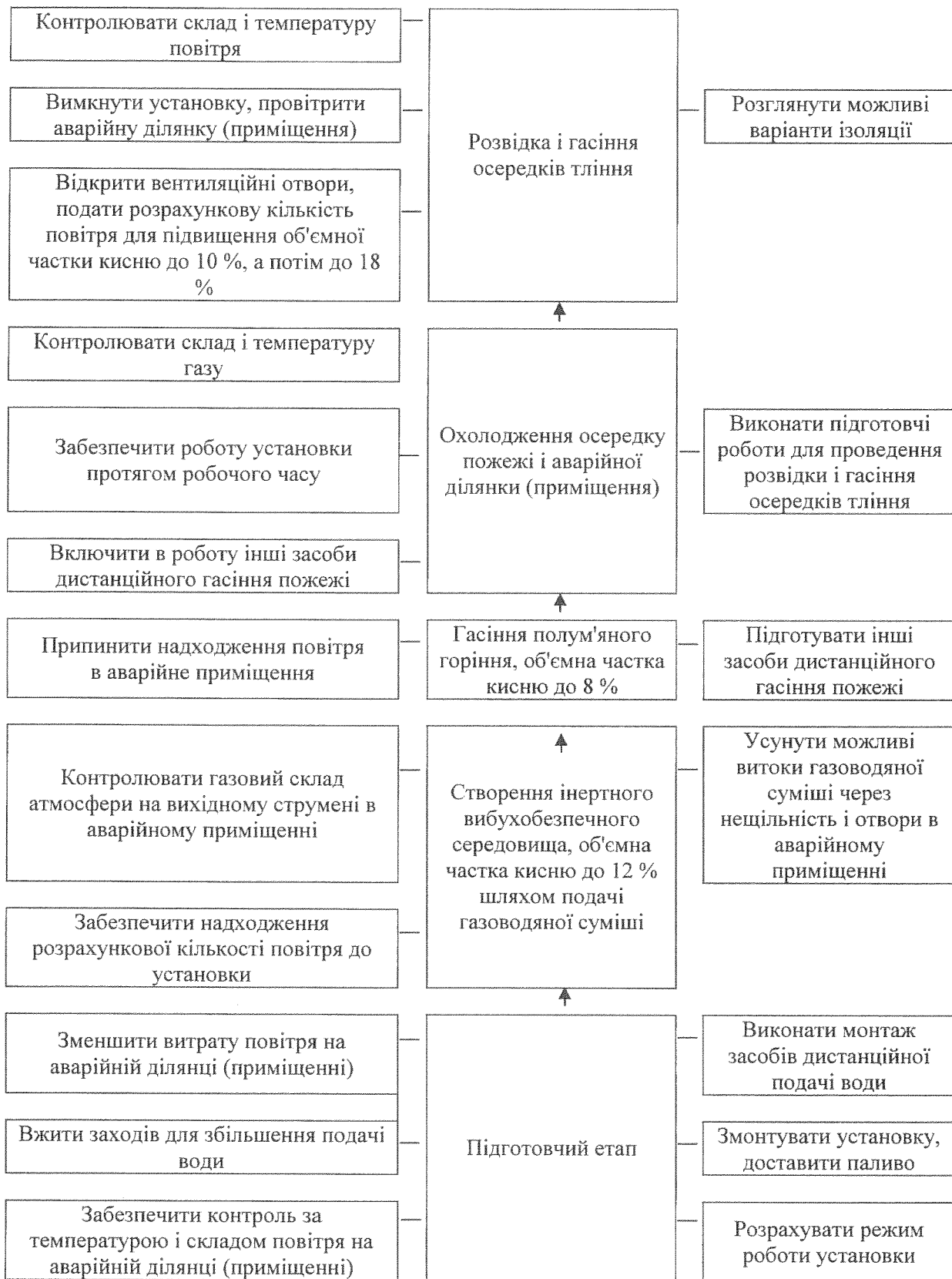
Рис. 1. Блок схема тактико-технологічного застосування удосконаленої установки для гасіння пожежі парогазовою сумішшю на аварійній ділянці (приміщенні) виробничого об'єкта
