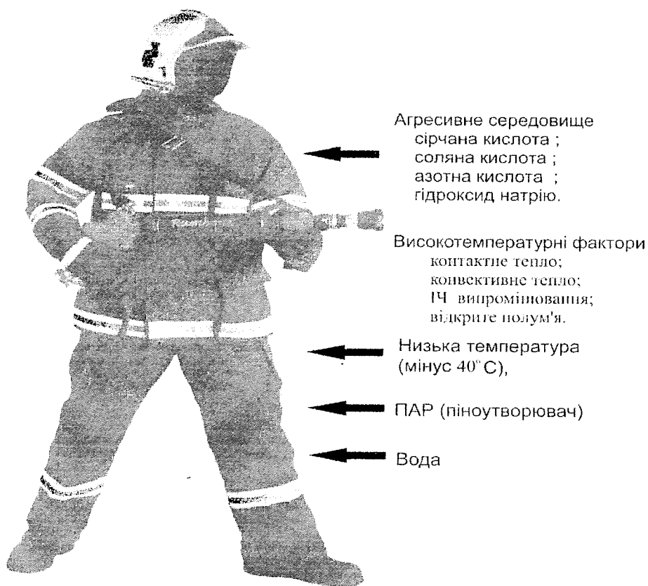
Рис. 1. Перелік температурних факторів та агресивних реагентів, що впливають на захисний одяг пожежника при ліквідації надзвичайних ситуацій
