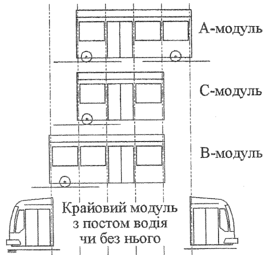
Рисунок 1 — Приклад модульної будови трамвайних вагонів: А, В, С — серединні модулі
