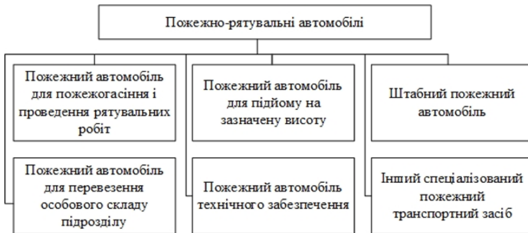
Рисунок 2 — Класифікація пожежно-рятувальних автомобілів відповідно до проекту ДСТУ-EN 1846-1
