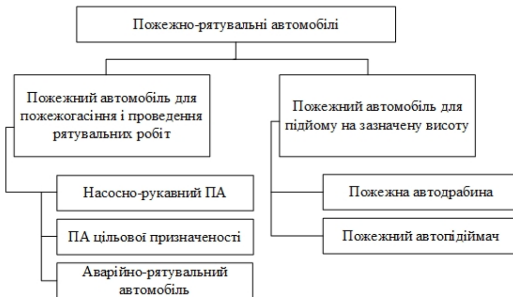
Рисунок 4 — Запропонована класифікація пожежно-рятувальних автомобілів
