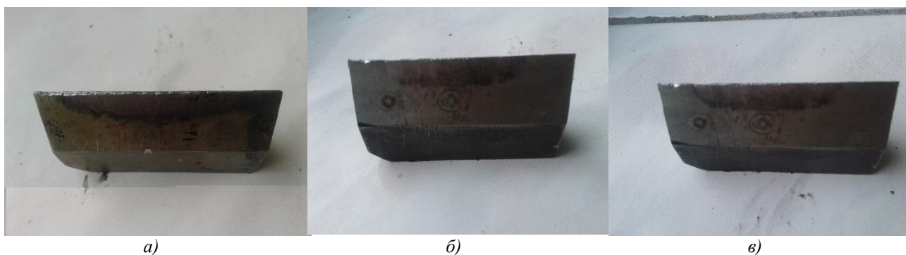
Рисунок 2 – Вигляд взірців після проведення дослідження в експлуатації: а) ножі заводського виробництва; б) взірець Зр-1; в) взірець Зр-2
