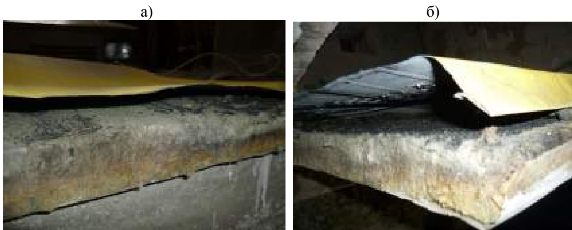
Рисунок 8 – Вигляд дослідного зразка після випробування: а) СПК-1; б) СПК-2
