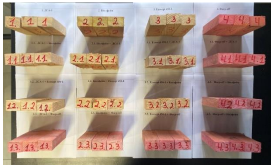
Рис. 1. 48 зразків, що просочені вогнезахисними засобами ДСА-1, Біофлейм, Ecossept 450-1, Фаєр-оф окремо кожним засобом і надалі в різних комбінаціях заміни вогнезахисного засобу
