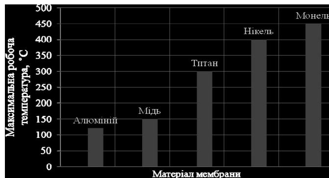
Рисунок 1 – Залежність максимальної температури експлуатації мембрани від виду матеріалу мембрани
