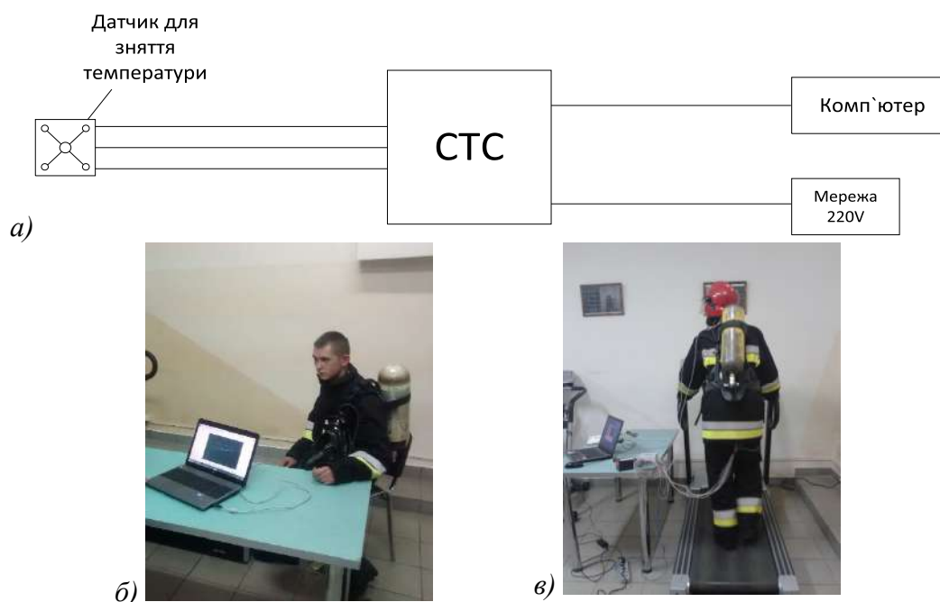
Рис. 5. Схема та процес зняття температури підкостюмного простору: а) схема підключення приладів для вимірювання температури; б, в) зображення проведення випробування.
