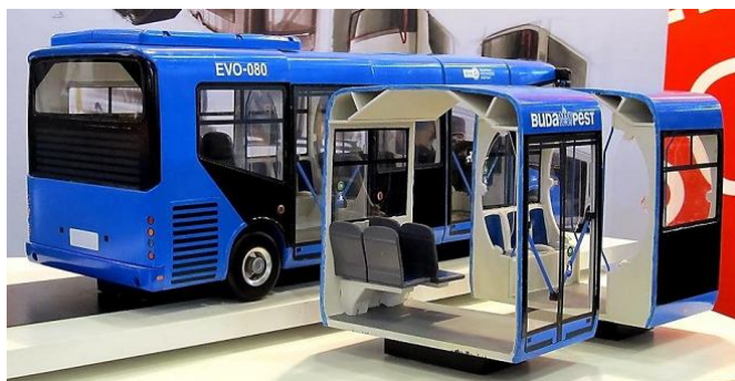
Рисунок 23 — Макети міського низькопідлогового автобуса моделі EP080 і серединних модулів його кузова угорської фірми EvoPro (Міжнародний автобусний салон Busworld Kortrijk, 2013-й рік)
