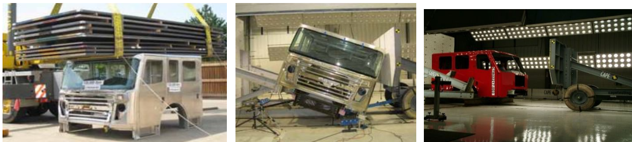
Рисунок 26 — Перевірка кабіни на міцність
