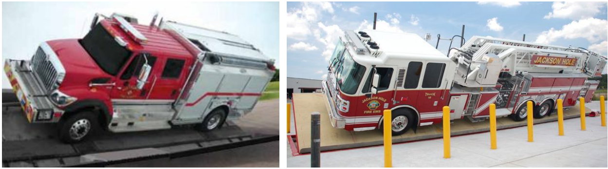
Рисунок 27 — Тестування шасі на поперечну стійкість
