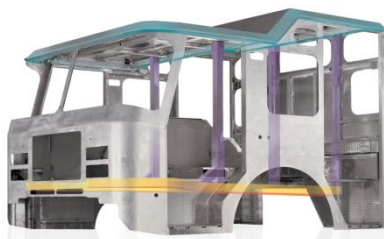
Рисунок 13 — Кабіна E-One Turphoon з каркасом із надміцної сталі
