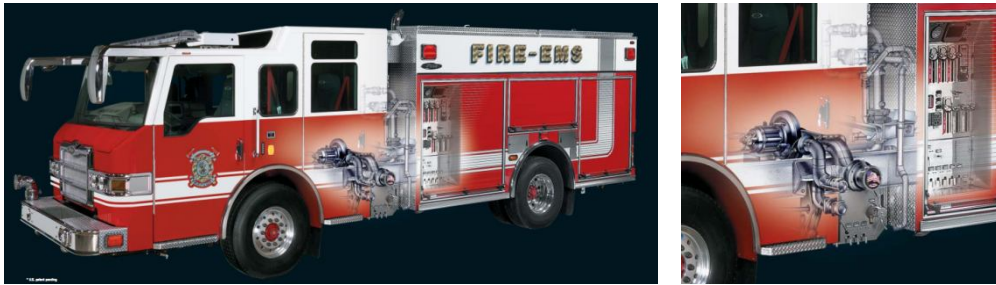
Рисунок 16 — Автоцистерна Pierce PUC з помпою, розташованою позаду кабіни
