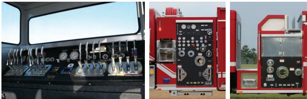
Рисунок 17 — Варіанти розташування пульта управління помпою
