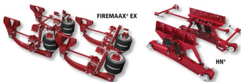
Рисунок 11 — Підвіски Hendrickson HN (праворуч) та Firemaax (ліворуч)
