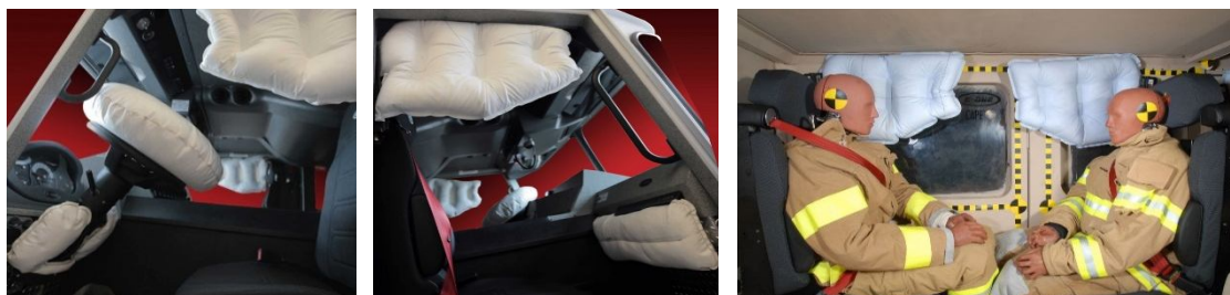
Рисунок 25 — Подушки безпеки та сидіння з пасами безпеки
