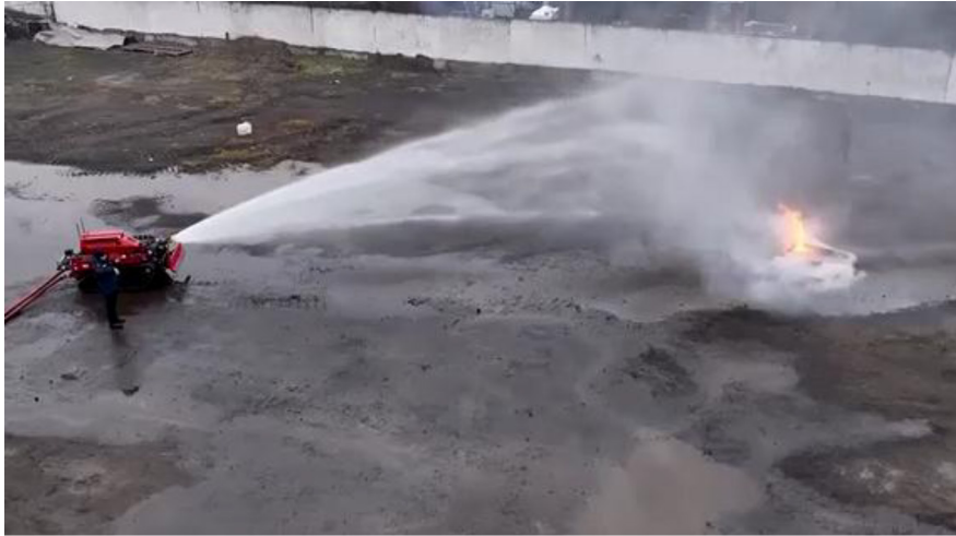
Рис. 3. Процес випробування НРК під час гасіння пожежі резервуару з легкозаймистою рідиною
