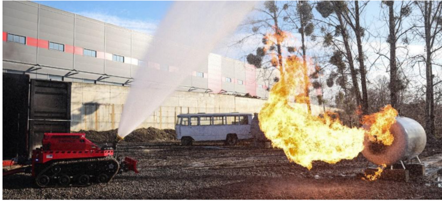
Рис. 5. Перевірка здатності НРК виконувати гасіння пожеж, які пов'язані з витоком горючого газу з резервуарів, в яких він зберігається
