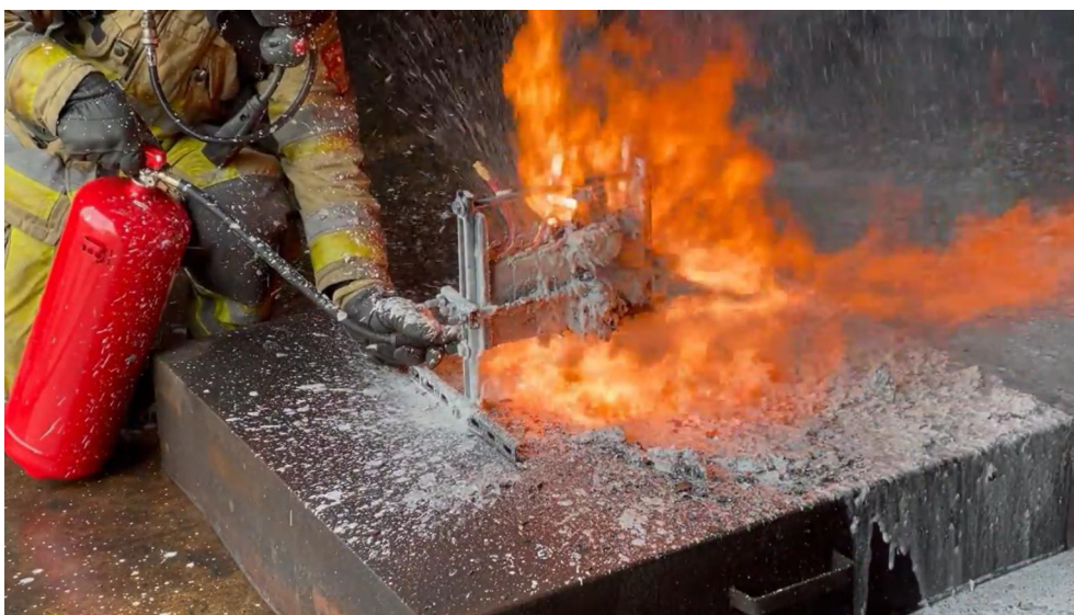
Рис. 4. Процес гасіння літій-іонних акумуляторів [24]
