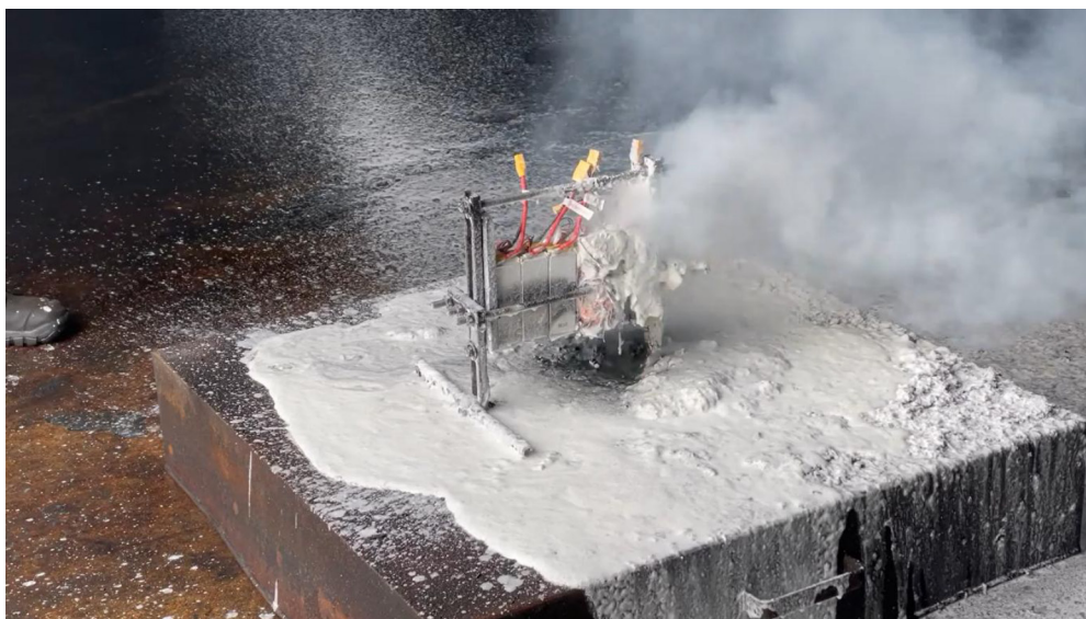
Рис. 5. Стан акумуляторних батарей після завершення процесу гасіння [24]
