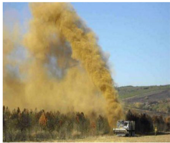
Рис. 2. Пожежний грунтометач «Extinción incendios tierra-tierra» іспанської фірми EXiTT
