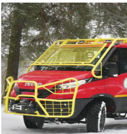
Рис. 3. Пожежний автомобіль для гасіння лісових пожеж АЛП-7 (55S18)-538I
