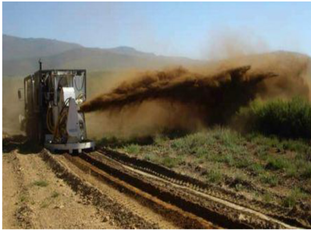
Рис. 2. Пожежний грунтометач «Extinción incendios tierra-tierra» іспанської фірми EXiTT
