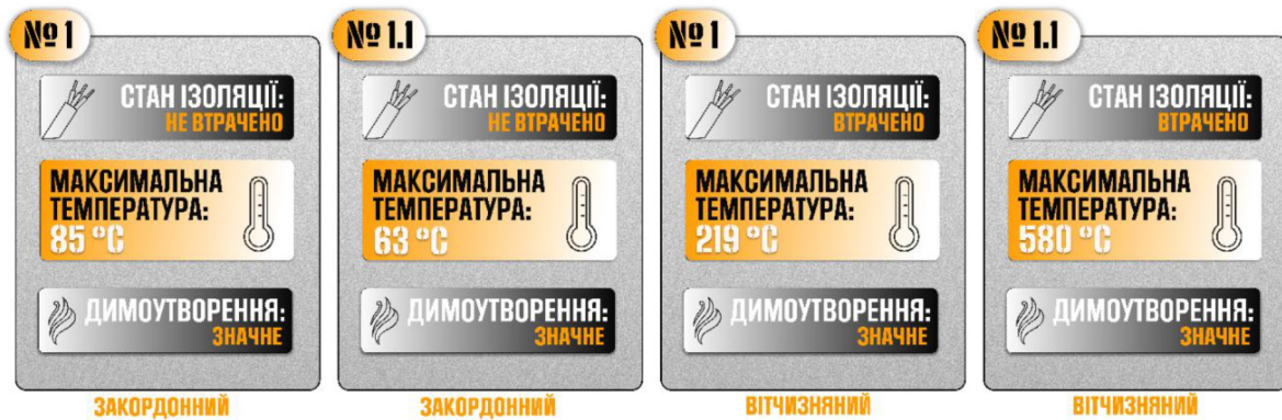
Рис. 6. Порівняльна характеристика з'єднувачів за результатами проведення дослідів
