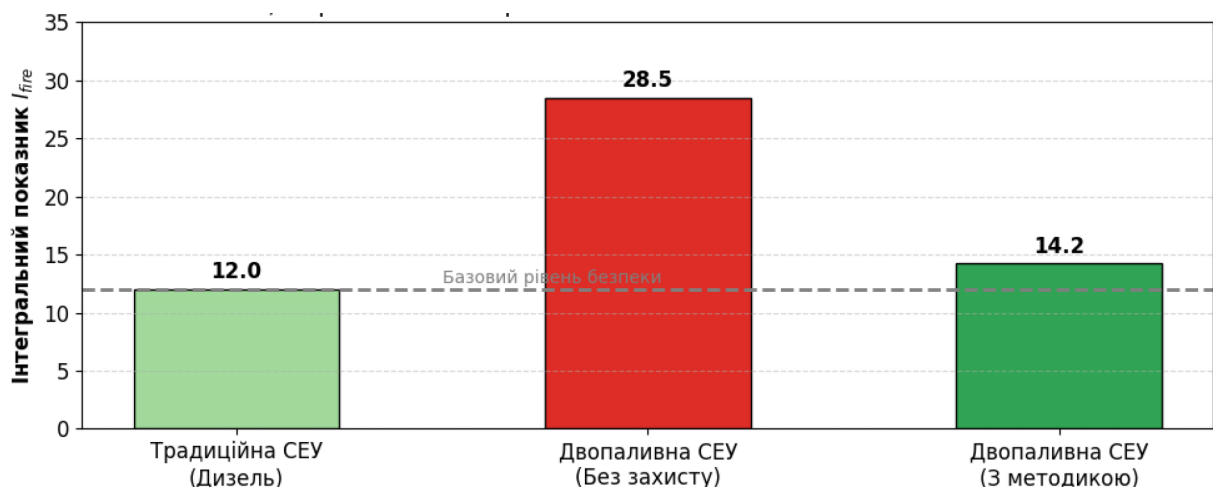
Рис. 5. Порівняння інтегрального показника пожежної небезпеки для трьох конфігурацій: базова дизельна СЕУ, двопаливна СЕУ без додаткових заходів, двопаливна СЕУ з оптимізованими конструктивно-технологічними рішеннями
