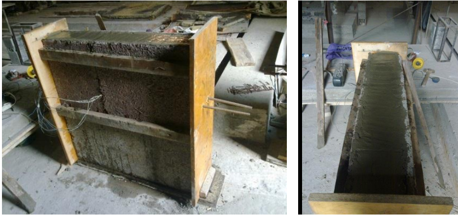
Рис. 4. Конструкція та загальний вигляд дослідного зразка марки СФБ
