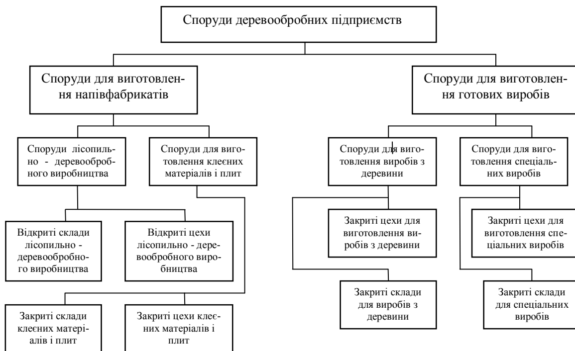
Рис. 1. Схема класифікації споруд деревообробних підприємств
