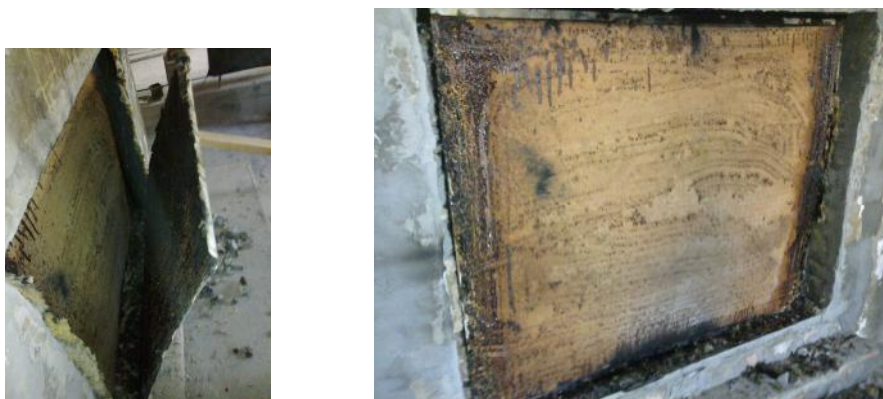
Рис. 5. Вигляд зразків СПІМ-6 після випробувань
