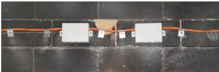
Рис 2. Зразок монтажу в кабельну лінію блоків комутації №1 і №2 (а) та коробок вогнестійких розподільчих №1 і №2 (б) до випробовувань
