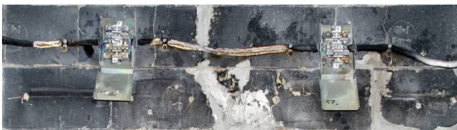
Рис 2. Зразок монтажу в кабельну лінію блоків комутації №1 і №2 (а) та коробок вогнестійких розподільчих №1 і №2 (б) до випробовувань
