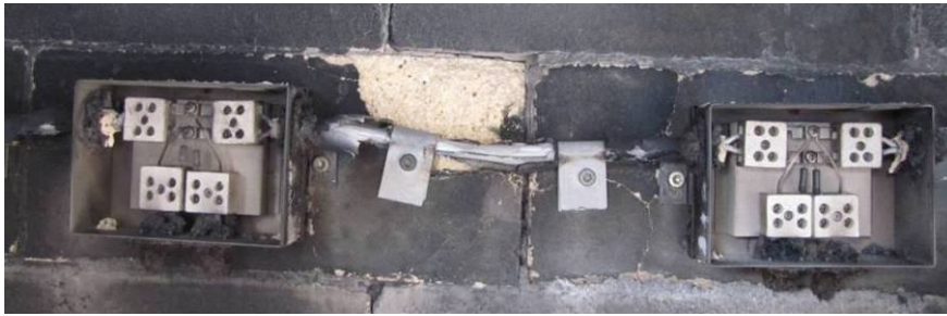
Рис 3. Зразок монтажу в кабельну лінію блоків комутації №1 і №2 (а) та коробок вогнестійких розподільчих №1 і №2 (б) після випробовувань
