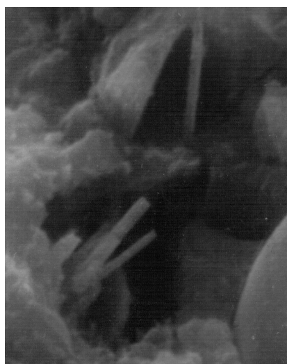
Рис. 2. Мікроструктура каменю на основі портландцементу ПЦ І-500, гідратованого 7 діб
