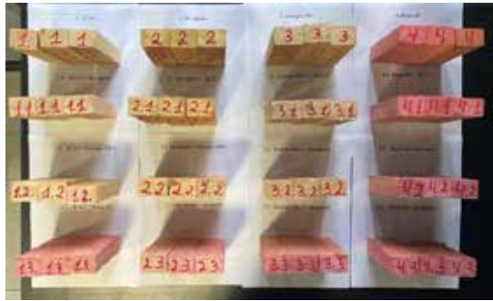
Рис. 1. 48 зразків, що просочені вогнезахисними засобами ДСА-1, Біофлейм, Ecossept 450-1, Фаєр-офф окремо кожним засобом і надалі в різних комбінаціях заміни вогнезахисного засобу
