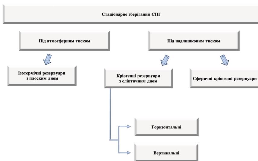
Рис. 5. Класифікація стаціонарних сховищ для зберігання СПГ
