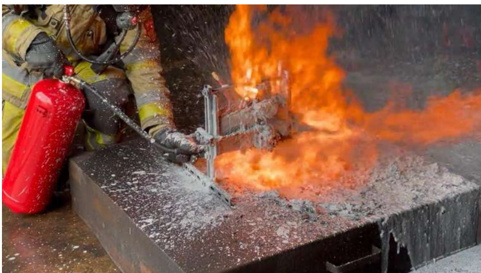
Рис. 4. Процес гасіння літій-іонних акумуляторів [24]
