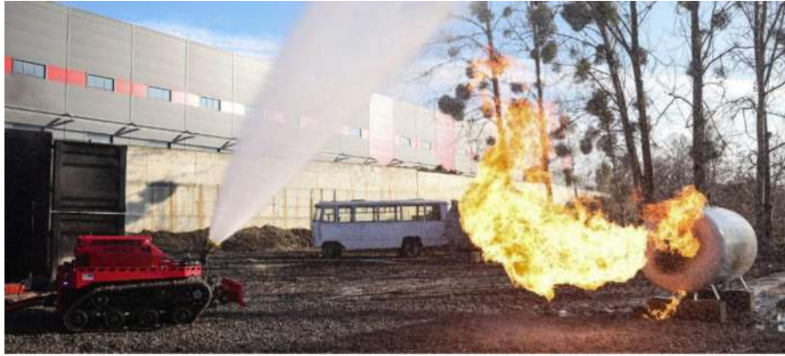
Рис. 5. Перевірка здатності НРК виконувати гасіння пожеж, які пов'язані з вибухом горючого газу з резервуарів, в яких він зберігається
