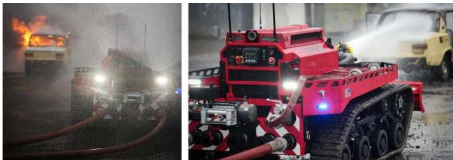
Рис. 2. Процес випробування НРК під час гасіння пожежі на транспорті
