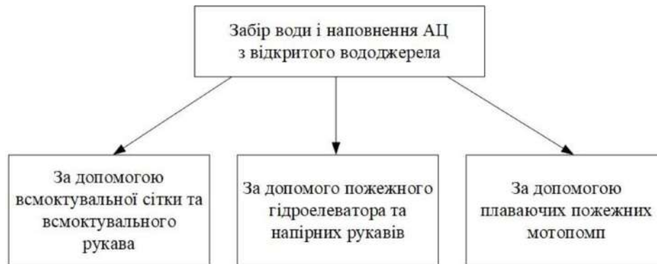
Рис. 4. Блок-схема забору води із відкритих вододжерела пожежною автоцистерною
