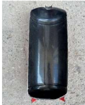
Рисунок 1 – Розрізаний корпус вогнегасника з тріщиною у внутрішньому полімерному покритті до витримки в ньому розчину №1
