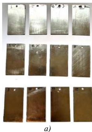
Рисунок 7 – Фото металевих пластин до (а) і після (б) їх витримки у робочих розчинах піноутворювачів «Барс S-1» та «Барс S-2» з додаванням карбозоліну, оксиетилідендифосфонові кислоти та без них
