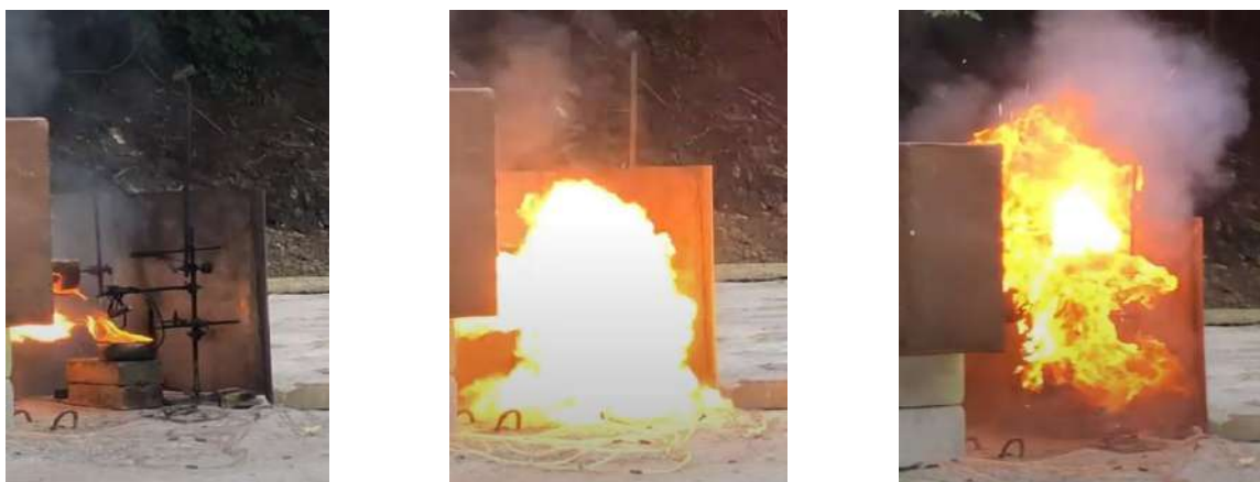
Рисунок 13 – Початок викиду вентиляційних газів і їх горіння
