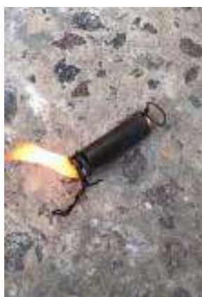
Рисунок 15 – Фото горіння заряджених батареї на 100% після вибуху
