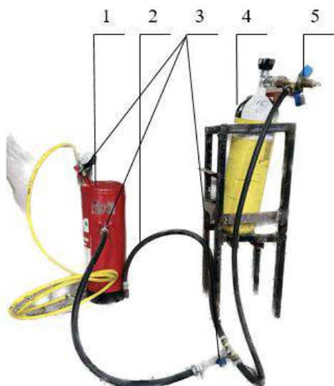
Рисунок 3 – Лабораторна установка типу вогнегасника для генерування компресійної піни:
