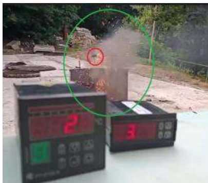
Рисунок 14 – Фото польоту батареї при 100% заряді із викидом частинок розпеченого металу та іскор
