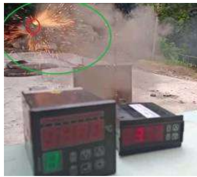
Рисунок 14 – Фото польоту батареї при 100% заряді із викидом частинок розпеченого металу та іскор
