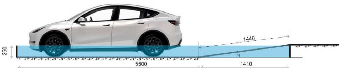
Рисунок 2 – Загальна схема облаштування паркувального місця для електромобіля на закритому паркінгу
