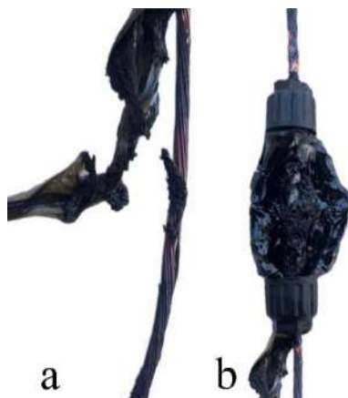
Рисунок 8 – Провідник(а) та з'єднання типу MC-4(б) після проведення випробування
