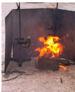
Рисунок 4 – Викид палаючих газів через вентиляційний отвір
