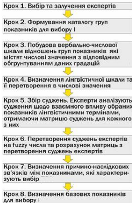
Рисунок 1 – Процес визначення основних груп показників і базових показників для вибору пожежно-рятувального обладнання
