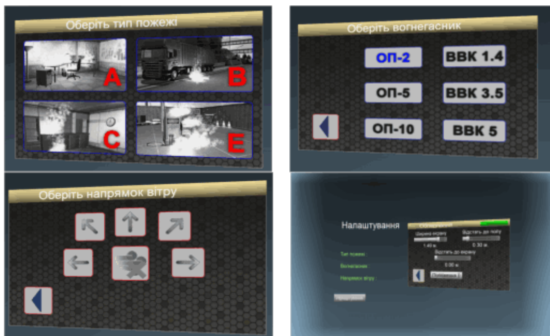
Рисунок 1 – Функціонал різних режимів роботи тренажера «СИМ-1» (вигляд від користувача)
