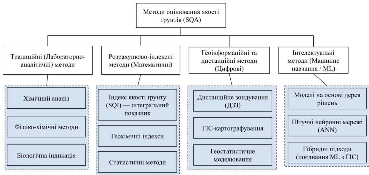
Рисунок 2 – Класифікаційна схема методів оцінювання якості ґрунтів
