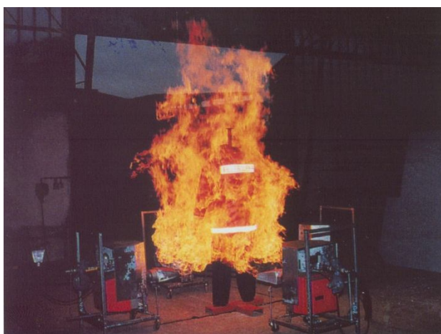
Рисунок 2 – Газові пальники, які використовуються для випробувань захисного одягу
