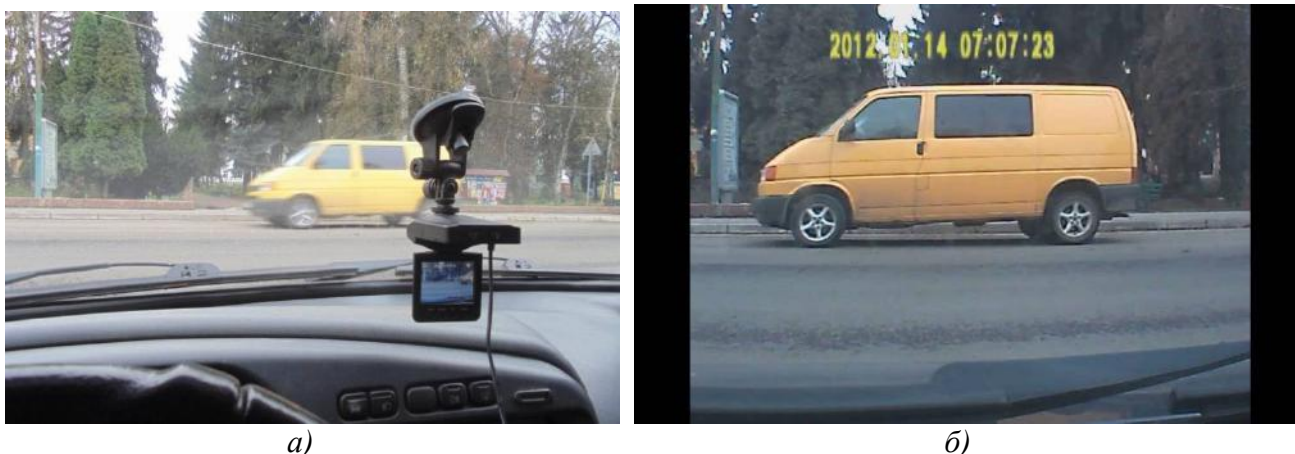
Рисунок 2 – Процес збору інформації для дослідження параметрів дорожнього руху: а – вигляд з кабіни автомобіля у момент фіксації транспортних засобів реєстратором; б – кадр із запису реєстратора, де відтворена дана інформація
