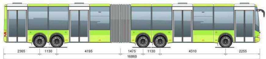
Рисунок 14 — Типорозмірний ряд міських автобусів з основним представником на трьох мостах (інтегральні модулі не цілком відповідають один одному)
