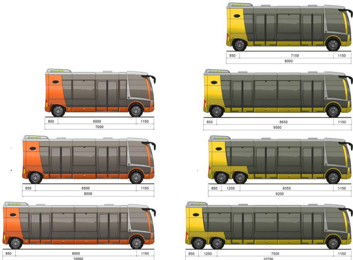
Рисунок 5 — ТРР модульно-уніфікованих автобусів з колісною формулою 4 \times 2.1
